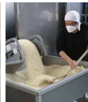
照片左上／發酵室(左手的建築物)及酒桶庫。酒桶庫共有4座 照片右上／蒸餾機中的燒酎釀造完成那一瞬間 照片左／透過橡木桶中熟成，使燒酎呈現口感滑順且多層次的琥珀色 照片右／使用滾筒式製麴機每次可穩定製作750kg的麴
