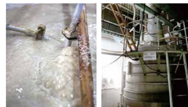
照片左上／一次、二次的釀造都是使用珓瑯桶槽。麴菌會依照商品，分別使用白、黑、黃麴 照片右上／首席釀酒師——藏座幸一先生的帶領下，熱情的酒工們在選原料、麴與酒醪的溫度管理、蒸餾.....所有的製程都進行徹底的管理 照片左／釀造採用地下水 照片右／『常樂酒造』中，依照品牌的個性會分別使用常壓蒸餾與減壓蒸餾
