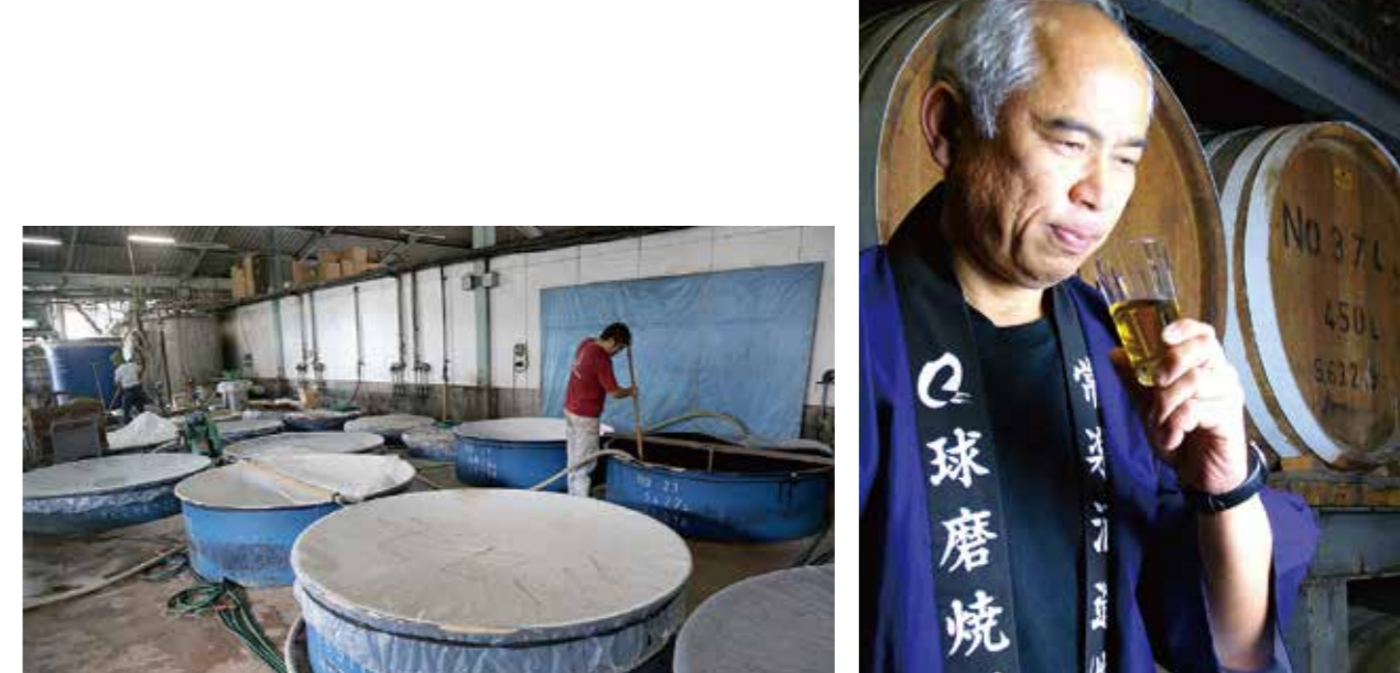
照片左上／一次、二次的釀造都是使用珓瑯桶槽。麴菌會依照商品，分別使用白、黑、黃麴 照片右上／首席釀酒師——藏座幸一先生的帶領下，熱情的酒工們在選原料、麴與酒醪的溫度管理、蒸餾.....所有的製程都進行徹底的管理 照片左／釀造採用地下水 照片右／『常樂酒造』中，依照品牌的個性會分別使用常壓蒸餾與減壓蒸餾
